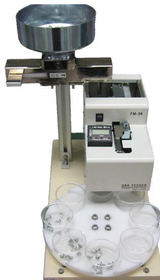
ネジをケースから取り出した後、レバーを回転させると、次分が自動的にカウント供給されます。ホッパからの供給はレバーを動かすことで、一定量補給できます。
